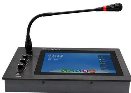
La Consola Micrófono IP Paging SIP-M20 (o estación de megafonía IP) es un equipo diseñado para captar una señal de voz local y convertirla en un flujo de audio digital que se transmite por la red IP mediante protocolos estándar (como SIP, RTP, etc.).
